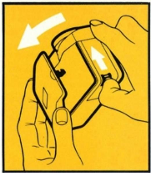
Verriegelung drücken, Camera-Rückdeckel aufklappen und Filmkassette einlegen.
